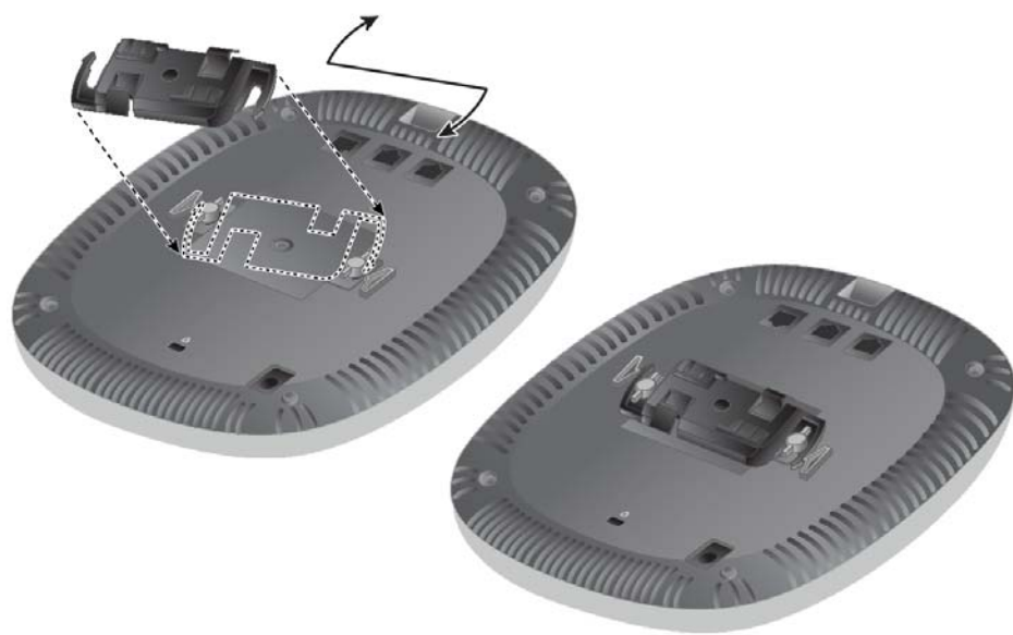
Abbildung 6 Anbringen des Adapters für Deckenschienen
